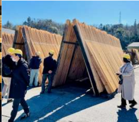
杉板天然乾燥場
