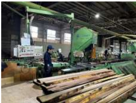
広葉樹の製材工程。樹種ごとに環境を調整して乾燥にかける
